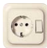
Розетка SCHUKO® с переключателем Подходит для монтажной коробки 60 мм. С винтовыми зажимами. Розетка: 16 А, AC 250 В, DIN 49440 Переключатель: 16 А, AC 250 В
