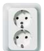
Двойная розетка SCHUKO® 16 А AC 250 В, DIN 49440 Подходит для одной монтажной коробки 60 мм. Со втычными зажимами.
