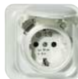
Розетка SCHUKO® с защитой от токов повреждения, с откидной крышкой и защитой от детей Повышенная защита от прикосновения согласно VDE 0620, часть 1. Для установки в монтажную коробку 60 мм.
