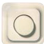
Светорегулятор с нажимным выключателем для омической нагрузки AC 230 В Для ламп накаливания и галогенных ламп 230 В. (Отсечка фазы по переднему фронту).
