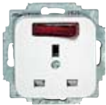
Механизм розетки британского стандарта 2-полюсная + E, 13 А, АС 250 В, с возможностью отключения С контрольной лампой и защитой от детей согласно BS 1363, подходит для монтажной коробки 60 мм.
