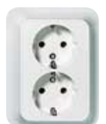
Двойная розетка SCHUKO® с защитой от детей 16 А AC 250 В, DIN 49440 Повышенная защита от прикосновения согласно VDE0620, часть 1. Подходит для одной монтажной коробки 60 мм. Для двух различных электрических цепей. Со втычными зажимами.
