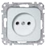
Механизм розетки без защитного контакта 16 А, 250 В CEE 7, стандарт I. С винтовыми зажимами. Без зажимов для винтового крепления.
